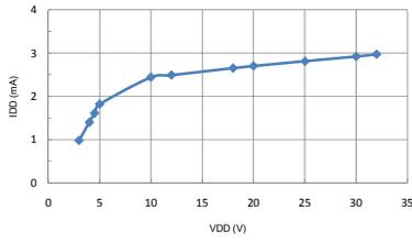
静态电流 vs. 工作电压
