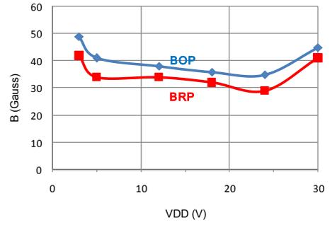
磁感应点 vs. 工作电压
